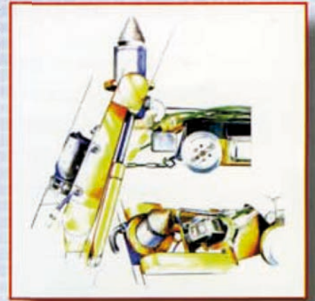
Fräsroboter zur Beseitigung von Unebenheiten im Rohr
